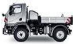
L'autocarro è una macchina utilizzata per il trasporto di mezzi, materiali da costruzione e/o di risulta da demolizioni o scavi, ecc., costituita essenzialmente da una cabina, destinata ad accogliere il conducente ed un cassone generalmente ribaltabile, per mezzo di un sistema oleodinamico.
