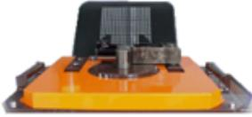
La macchina piegaferrì svolge la funzione di piegatura di barre di acciaio al fine di realizzare staffe e sagomati per il cemento armato.
