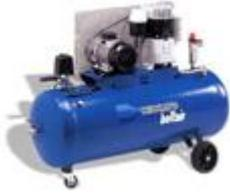
I compressori sono macchine per la produzione di aria compressa, che viene impiegata per alimentare macchine, come i martelli pneumatici, vibratori, avvitatori, intonacatrici, pistole a spruzzo, ecc. Sono costituite essenzialmente da due parti: un gruppo motore, endotermico o elettrico, ed un gruppo compressore che aspira l'aria dall'ambiente e la comprime.
