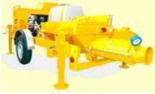
Pompa utilizzata per la spruzzatura di calcestruzzo. Prima dell'utilizzo occorrerà verificare l'efficienza degli interruttori di comando, delle tubazioni e dei cavi di alimentazione, controllare gli innesti tra condutture e macchina e l'efficienza dei carter degli organi di trasmissione e del nastro trasportatore.
