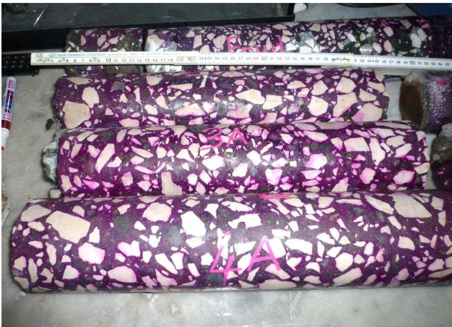
foto n°3 - Prova di carbonatazione su carote
