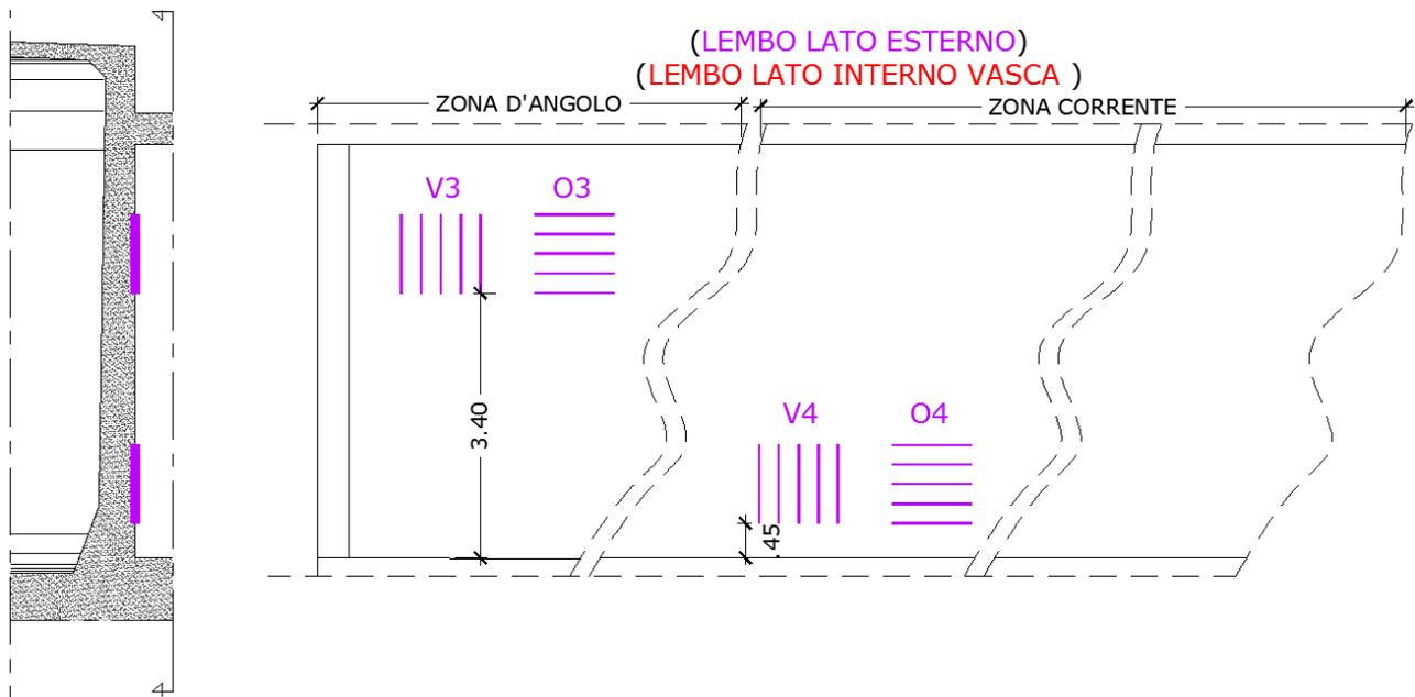
I saggi di riferimento per i paramenti esterni delle pareti perimetrali corte delle vasche sono l'**S2a** e l'**S2b**. Il primo si colloca ad una altezza intermedia ed in prossimità dello spigolo della vasca mentre il secondo e' realizzato allo spiccato circa al centro di uno dei 4 corridoi in cui e' la vasca e'
